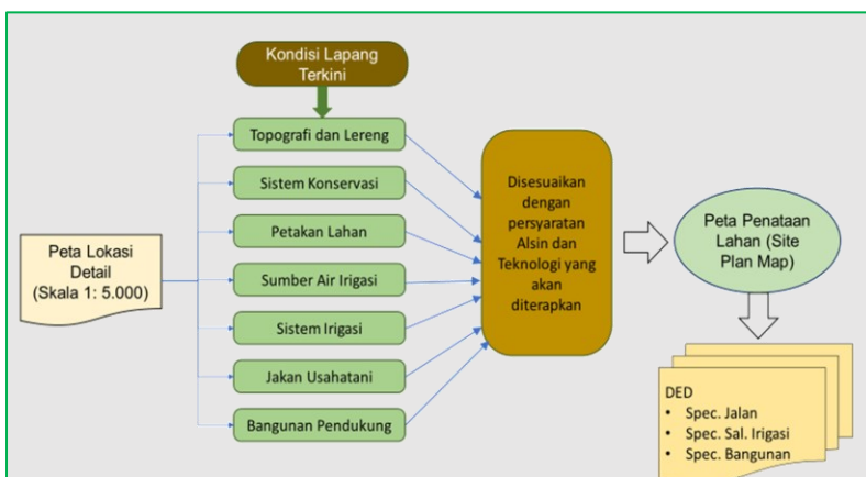
Gambar 3.3. Tahapan Penyusunan DED
